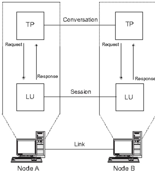
Abbildung 3. Kommunikation zwischen Transaktionsprogrammen und logischen Einheiten
