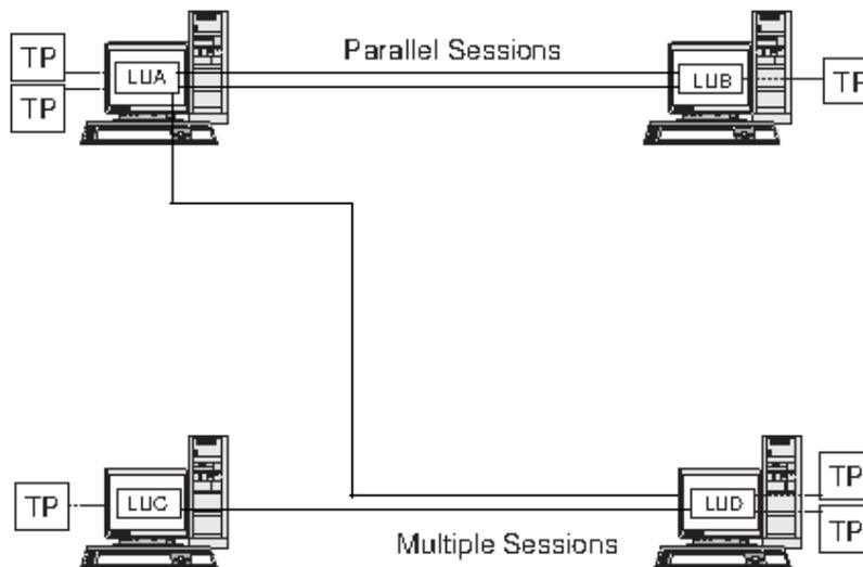
Abbildung 2. Mehrfachsitzungen und Parallelsitzungen
