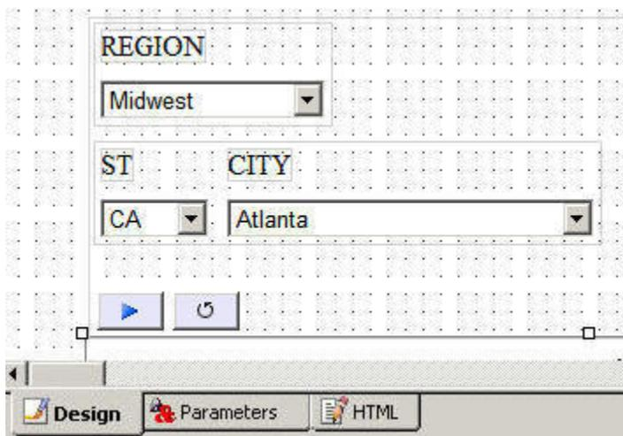
[パラメータ] (Parameters) タブでは、連鎖はコントロールオブジェクトの接続線として表示されます。たとえば、REGION フィールドで選択した値は、この連鎖の CITY フィールドで使用可能な値を入力します。
