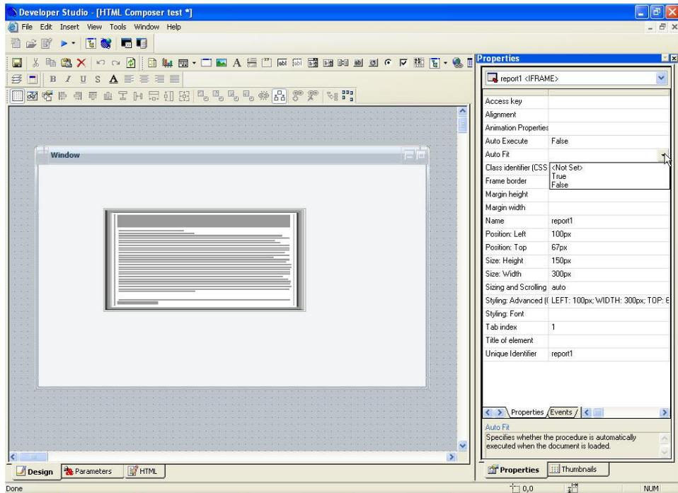
下図は、デザイン表示のレポートを示しています。サイズが自動的に変更され、ウィンドウ全体に表示されています。このプロパティは、実行時にも保持され、ウィンドウのサイズが変更された場合は、レポートのサイズも変更されます。
