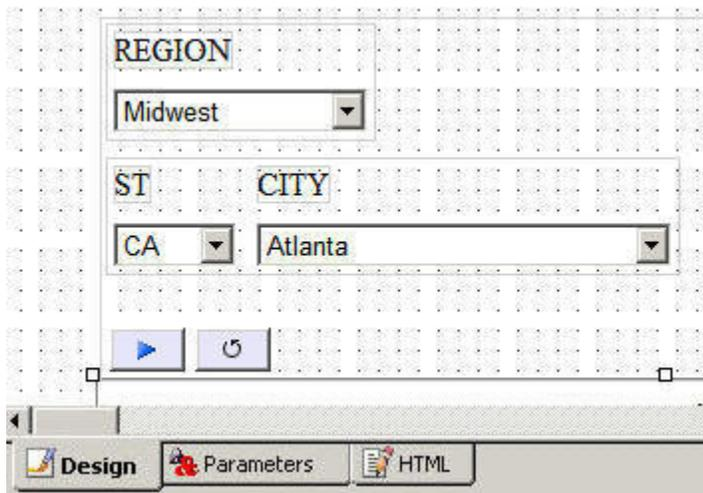
[パラメータ] (Parameters) タブでは、連鎖はコントロールオブジェクトの接続線として表示されます。たとえば、REGION フィールドで選択した値は、STATE フィールドで使用可能な値を入力します。STATE フィールドで選択した値は、この連鎖の CITY フィールドで使用可能な値を入力します。
