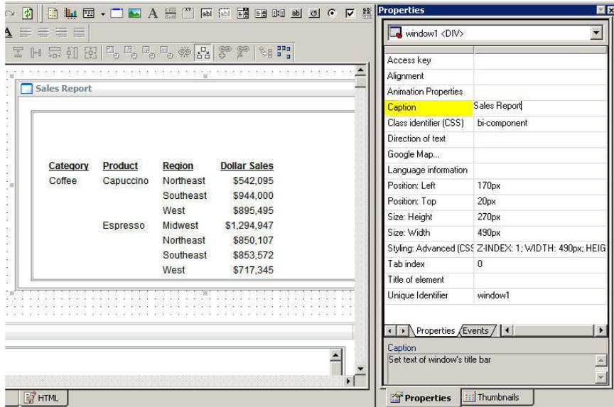
7. ウィンドウコンポーネント自体、およびそのウィンドウ内の任意の子オブジェクトにアニメーションを設定することができます。オブジェクトを選択し、[プロパティ] (Properties) ウィンドウの [アニメーションのプロパティ] (Animation Properties) で、位置、サイズ、透明度を設定します。アニメーションのプロパティについての詳細は、94 ページの「[RIA へのアニメーションプロパティの適用](#)」を参照してください。
