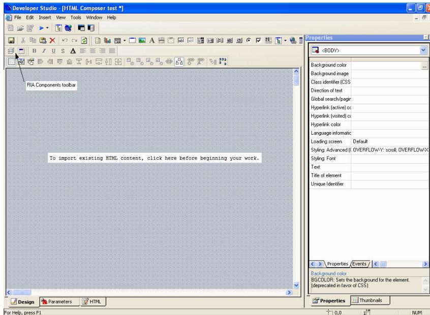
4. [コンポーネント] (Component) ツールバーを使用して、レイアウトにボタンやイメージなどのオブジェクトを追加します。
