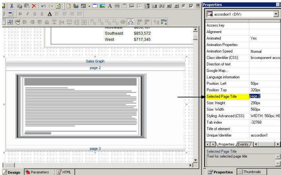
8. アニメーションのオンオフ、およびページ切り替え時のアニメーション速度を設定し、RIA でのアコーディオンページ速度の動作に関して、アコーディオンコントロールのプロパティを設定することができます。
