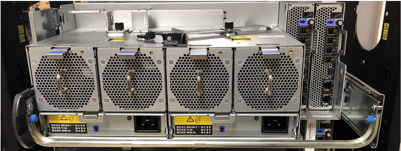
Figure 49. La barre transversale avec les vis moletées bleues stabilise les deux rails à l'arrière du châssis
