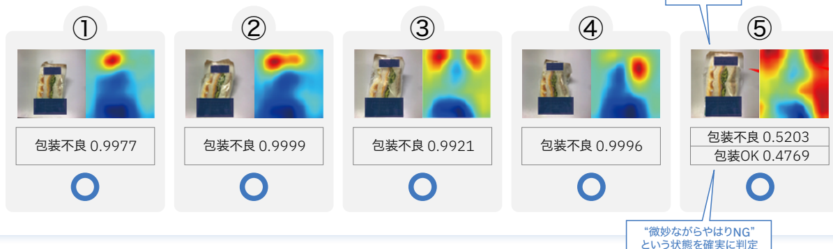
図1 チューニング後の分析モデルによる包装不良画像の判定結果
