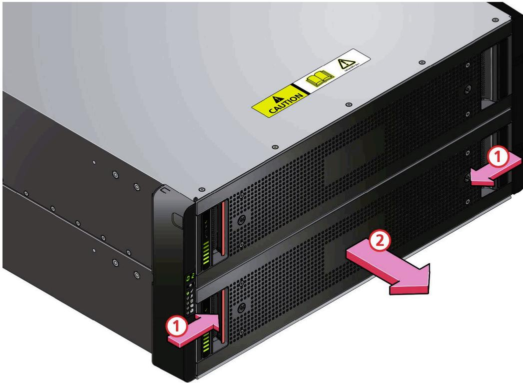
Figura 28. Apertura del cajón inferior
