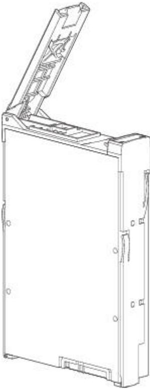
Рисунок 72. Крепежный модуль накопителя LFF в открытом положении
