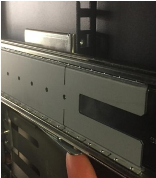
*Рисунок 33. Сведения о фиксирующей пружине*
