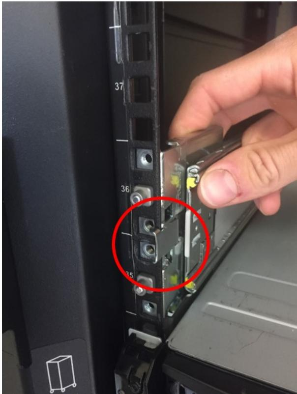
*Рисунок 35. Фиксирующая пружина*
