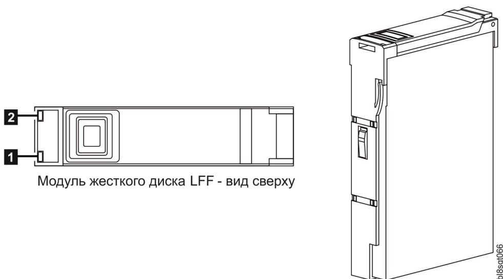
Рисунок 17. Индикаторы: двухканальные крепежные модули дисковых накопителей LFF 3.5" – верхняя панель
