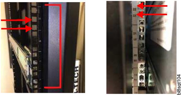
*Рисунок 36. Сведения о расположении квадратных отверстий в опоре стойки*
