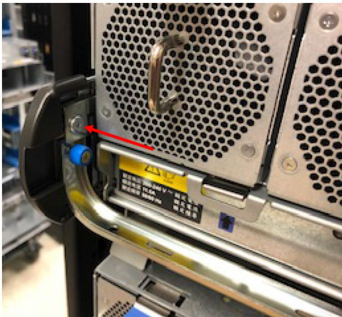
На рисунке выше установленный транспортировочный винт обозначается красной стрелкой. Транспортировочный винт устанавливается над каждым винтом с накатанной головкой поперечной планки (см. рисунок, на котором показана задняя панель корпуса).
