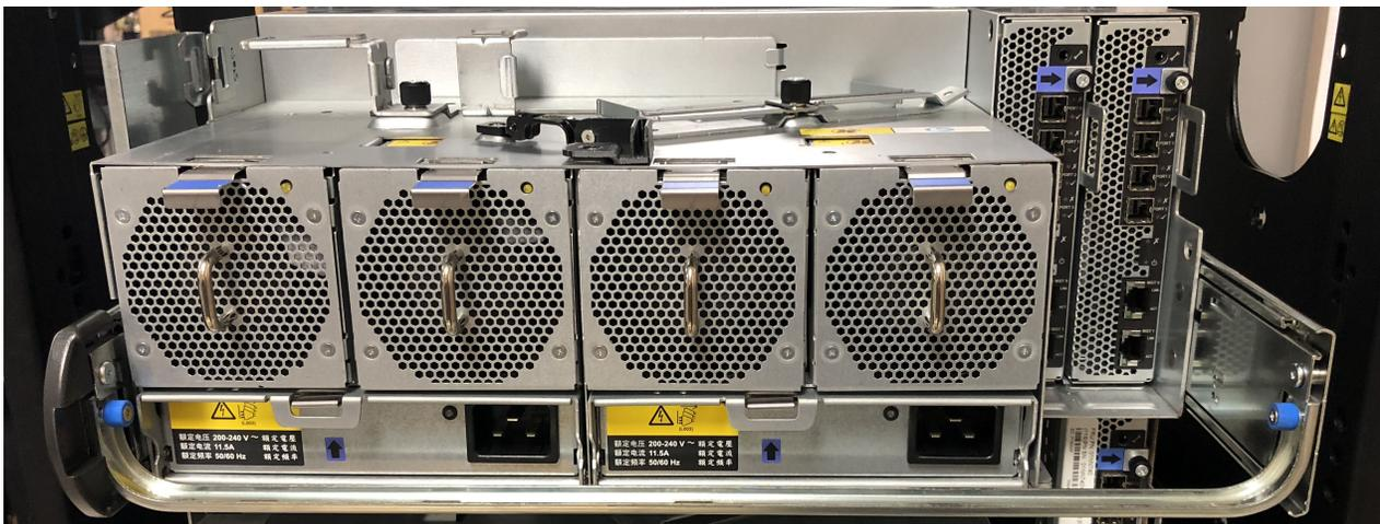
Рисунок 49. Поперечная планка с синими винтами с накатанной головкой стабилизирует две направляющие в задней части шасси
