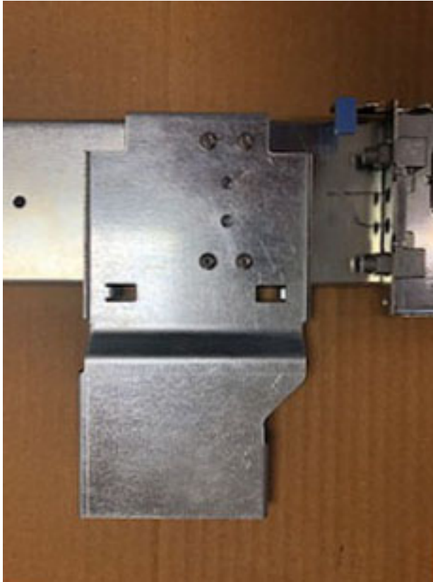
図 30. アウター・スライドに取り付けられた CMA アタッチメント
