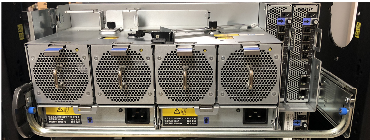
図 49. 青いつまみねじの付いたクロスバーでシャーシの背面にある 2 つのレールを安定させる
