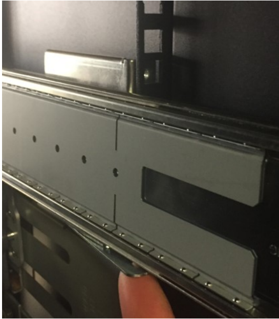
Figura 33. Detalle del muelle de acoplamiento
