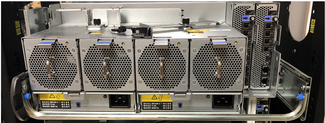
Figura 49. El travesaño con tornillos de mano azules estabiliza los dos rieles en la parte posterior del chasis
