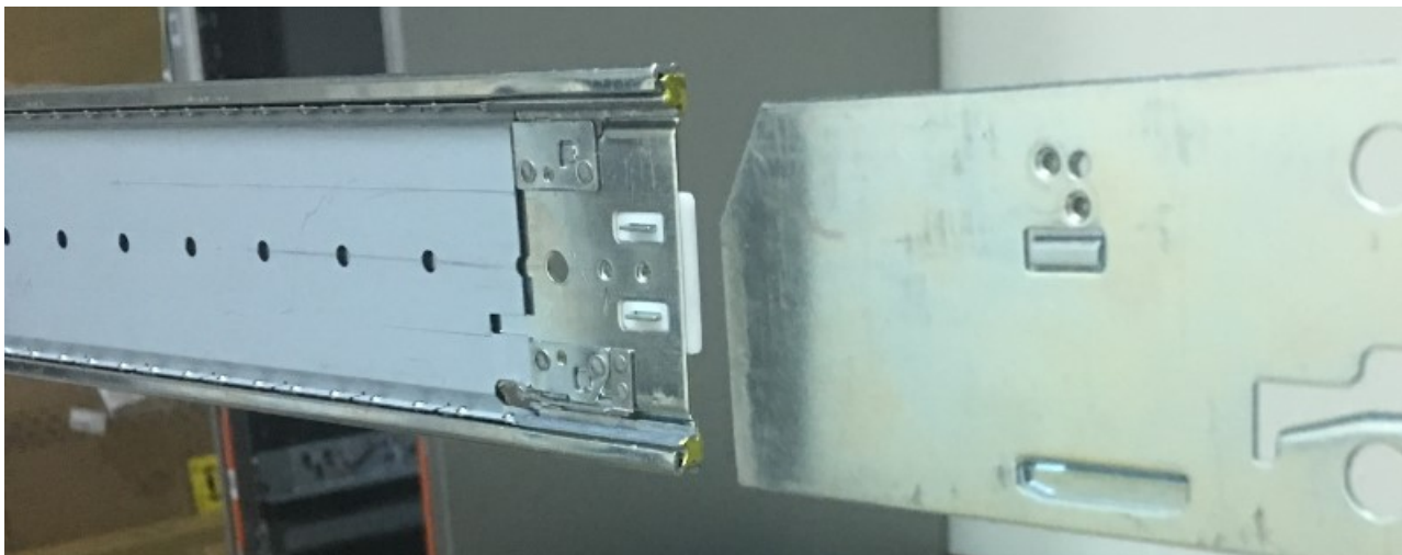
Figura 40. Detalle de la alineación del deslizamiento de los rieles
