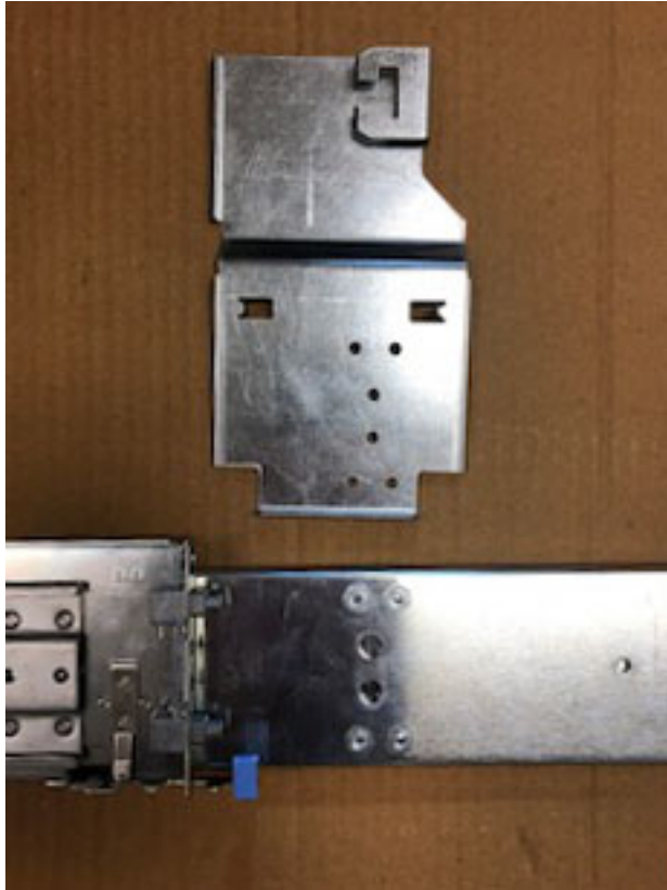
Figura 28. Pieza de fijación de CMA alineada con pieza deslizante exterior
