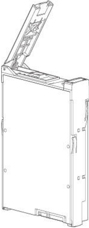
Figura 72. Módulo de portadora de unidad en posición abierta
