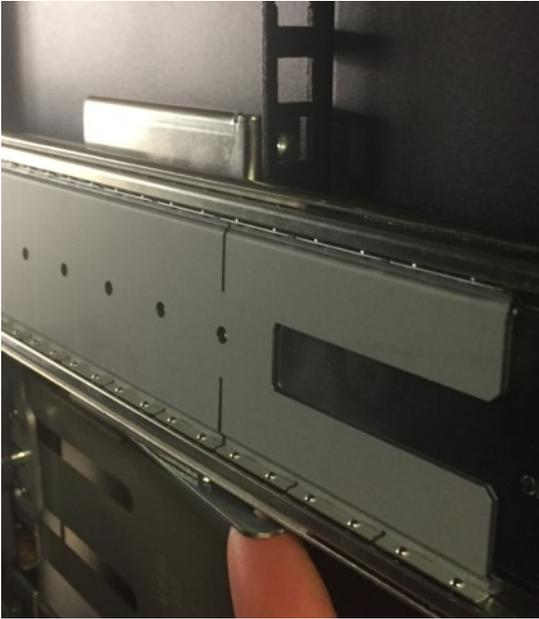
Abbildung 33. Details zur Befestigungsfeder
