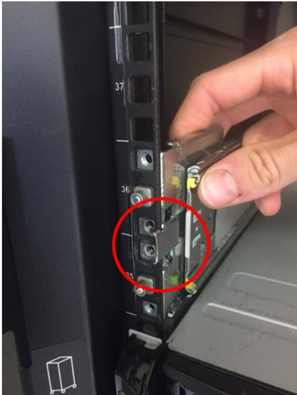
Abbildung 35. Befestigungsfeder
