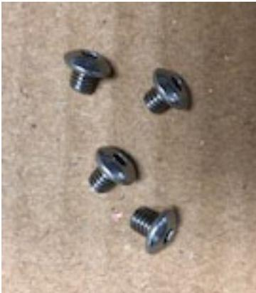
Abbildung 29. Flachkopfschrauben
