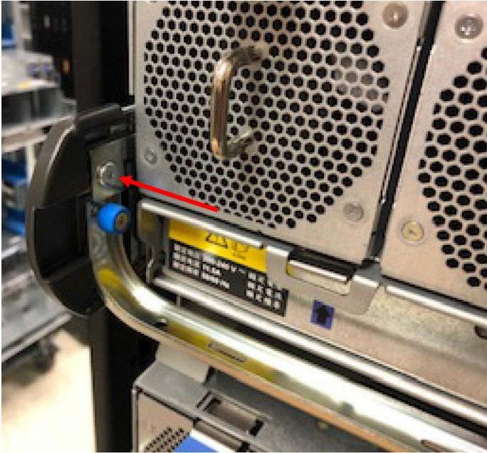
In der obigen Abbildung ist eine eingesetzte Transportschraube dargestellt (roter Pfeil). Jede Transportschraube wird über den einzelnen Rändelschrauben der Querschiene befestigt. Dies ist in der Ansicht der Gehäuserückseite (über diesem Schritt) abgebildet.
