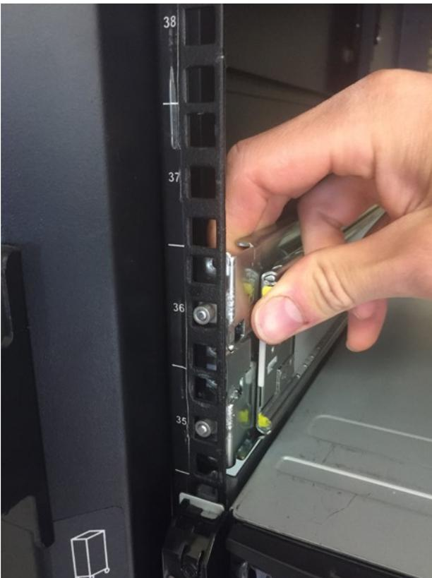
Abbildung 34. Details zur vorderen Befestigung am Rackpfosten
