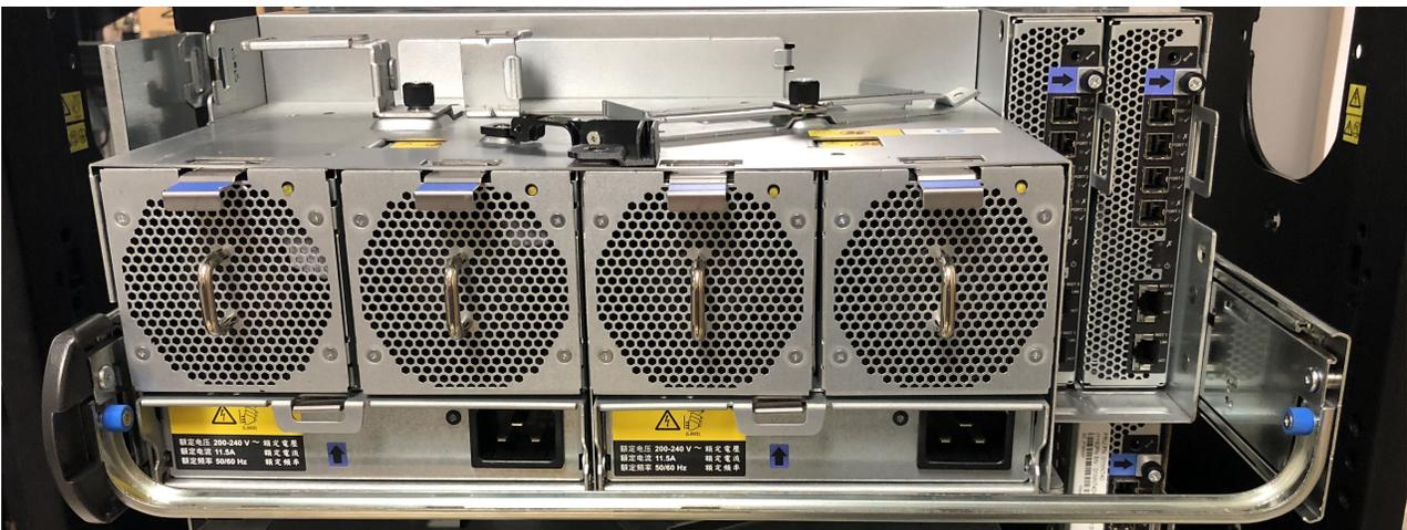
Abbildung 49. Querschiene mit blauen Rändelschrauben zur Stabilisierung der beiden Schienen an der Rückseite des Chassis
