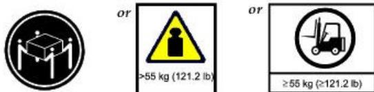
Dieses Teil oder diese Einheit wiegt über 55 kg. Zum Anheben dieses Teils oder dieser Einheit ist ausgebildetes Fachpersonal und/oder eine Hebevorrichtung erforderlich. (C011)
