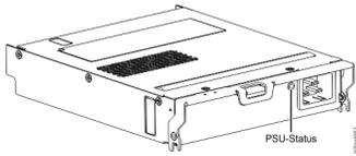
Abbildung 13. Stromversorgungseinheit mit Ausrichtung für die Verwendung im hinteren Steckplatz
