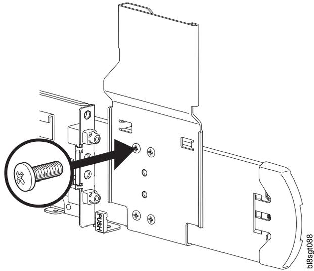
2. Fixez le crochet "C" du kit de glissières au châssis à l'aide de quatre vis (Article 1 sous le tableau 1, à la page 1) M4x4 PH. Couple : 12 lbf-in.
