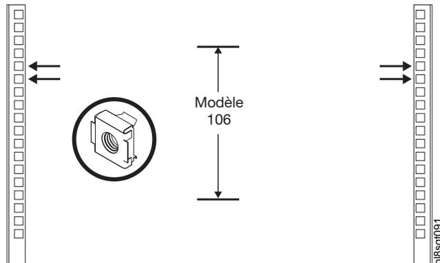
2. Utilisez dix vis (Article 2 sous le tableau 2, à la page 1) pour fixer les rails gauche et droit à l'armoire. Couple : 27 lbf-in.
