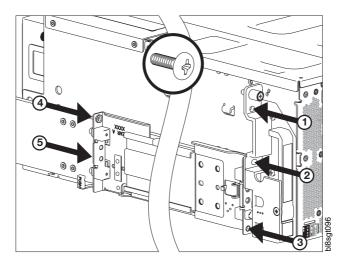
Die mit Sternchen (\*) versehenen Schrauben im Diagramm zu den Rackpfosten unten werden nur für Versand- und Transportzwecke verwendet. Die Chassisrändelschrauben und die Schienenschrauben an der Vorderseite unten sichern den Griff am Rackpfosten. Weitere Informationen finden Sie in den Anweisungen zur Installation des Gehäuses im *Installations- und Wartungshandbuch für Hardware - Modell* 106.
