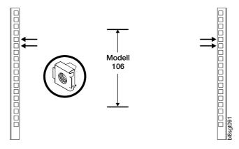
2. Befestigen Sie die linken und rechten Schienen mit zehn Schrauben (Element 2 unter Tabelle 2 auf Seite 1) am Rack. Drehmoment: 27 Pfund-Zoll.
