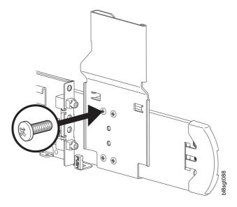
2. Befestigen Sie die Halterung "C" des Schienensatzes mit zwei Flachkopfschrauben vom Typ M4x4 (Element 1 unter Tabelle 1 auf Seite 1) am Chassis. Drehmoment: 12 Pfund-Zoll.
