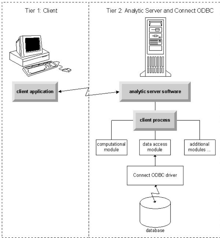
Рисунок 1. Connect ODBC в режиме распределенного анализа
