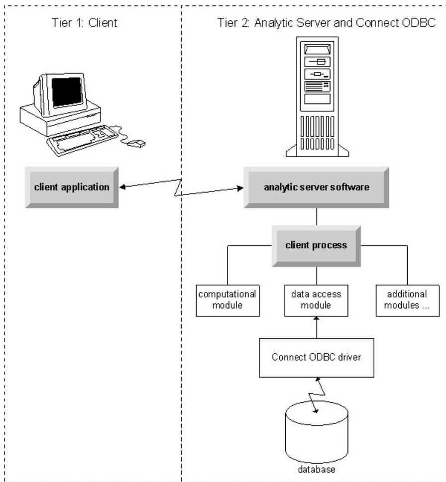
Figura 1. Connect ODBC en análisis en modo distribuido
