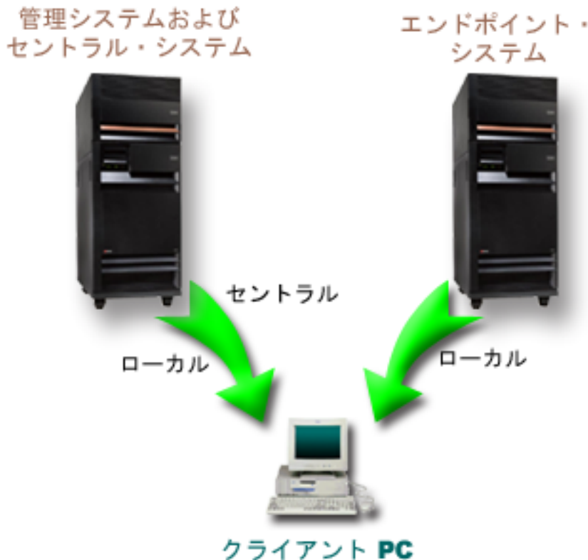
図3. 管理システムとセントラル・システムを同じシステムにすることができる。これにより、アプリケーション管理またはマネージメント・セントラルの機能が変更されることはない。クライアント PC がシステムに接続する場合、接続するシステムからローカル設定が送信される。管理システムに接続する場合には、セントラル設定は管理システムからクライアント PC に送信される。
