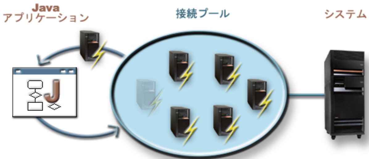
図 3: サーバーへの AS400ConnectionPool からの接続を取得する Java プログラム
