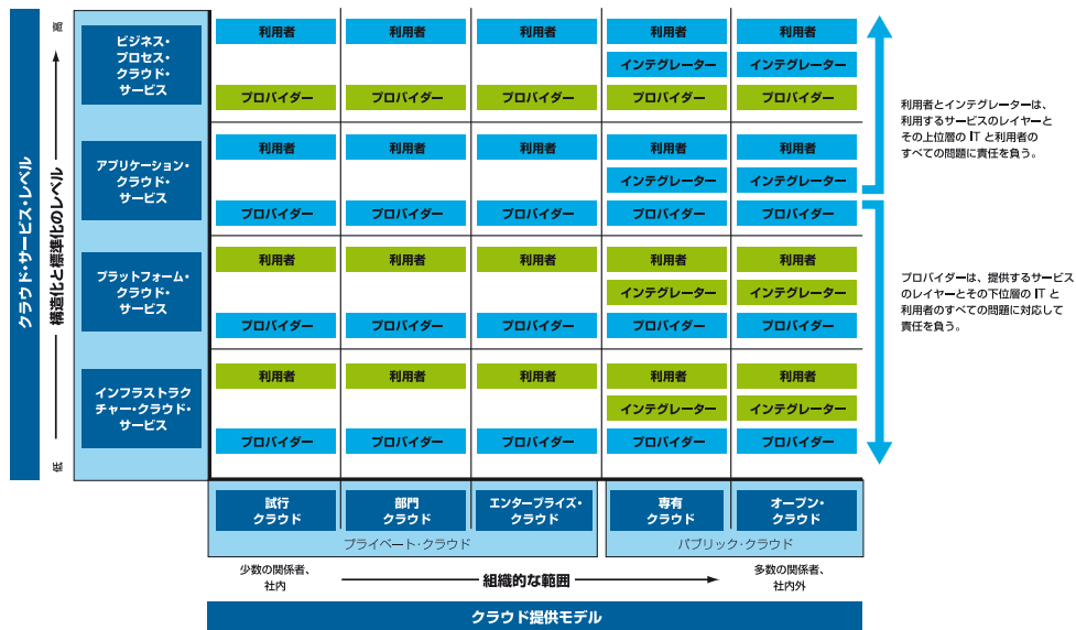
図 3: 役割と責任。クラウド・コンピューティング採用フレームワークは、パブリックとプライベートのクラウドにおける利用者、プロバイダー、インテグレーターの責任範囲を定義します。
